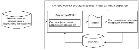
Рис. 5 — Архитектура системы оценки эксплуатируемости программных дефектов.
