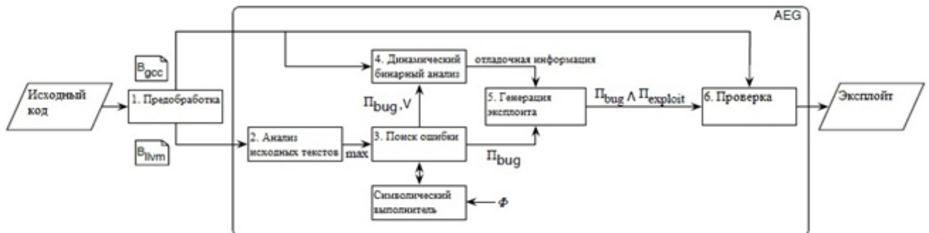
Рисунок 1.3 — Схема работы инструмента AEG.
