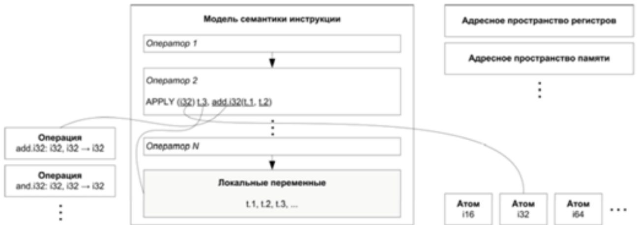
Рисунок 2.9 — Схема модели описания операционной семантики инструкции.
