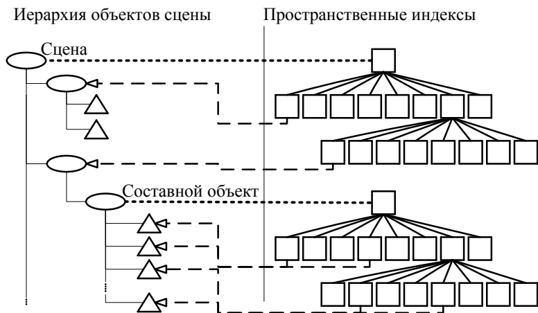
Рисунок 6. Структура индекса для иерархически организованных данных.
