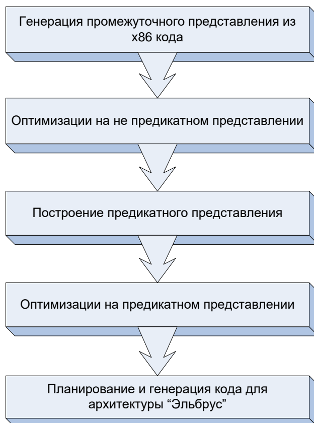
Рис. 4. Схема работы двоичного оптимизирующего транслятора для архитектуры “Эльбрус”
