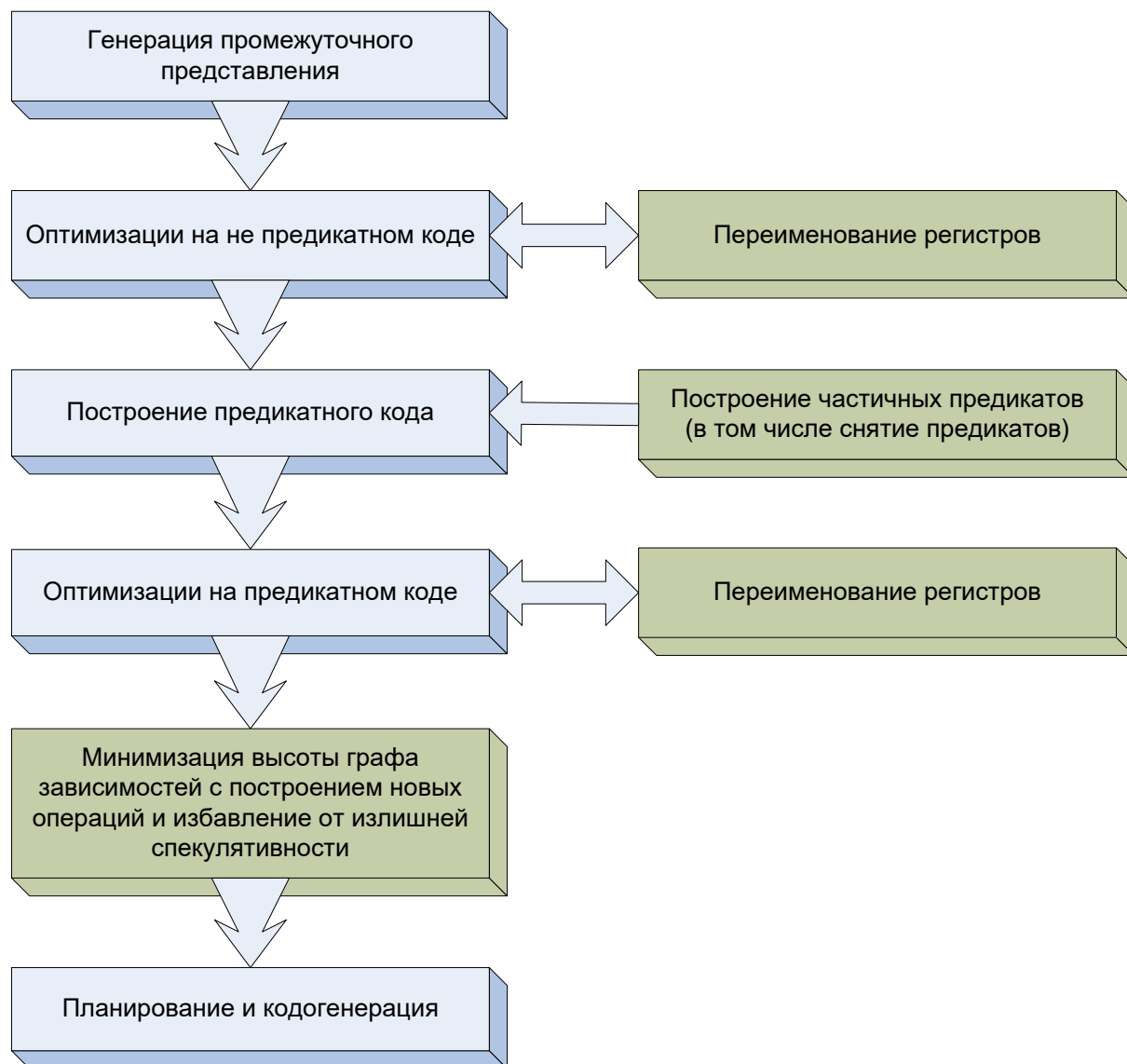
Рис. 18. Схема работы двоичного оптимизирующего транслятора для архитектуры “Эльбрус” с учётом всех используемых техник минимизации высоты графа зависимостей
