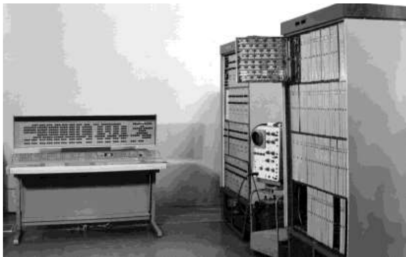
Рис. 14. Фрагмент экспериментального образца суперЭВМ 5Э53
