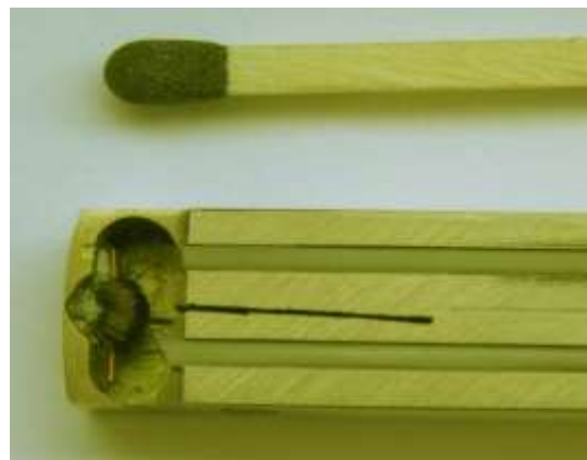
Фото 3. Магнитная головка в сравнении с «головкой» стандартной спички.
