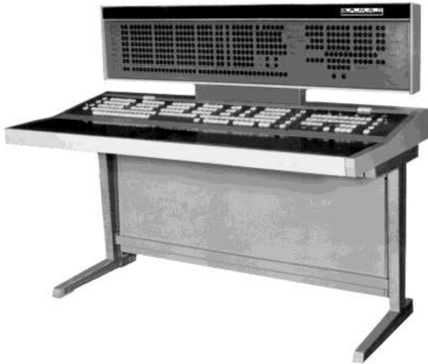
Рис. 12. Инженерный пульт управления ЭВМ Алмаз
